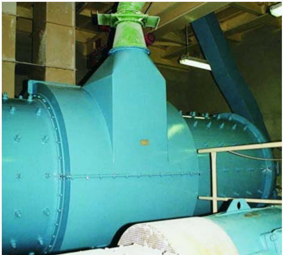
Doppelhartmühle mit Mittenaustrag
