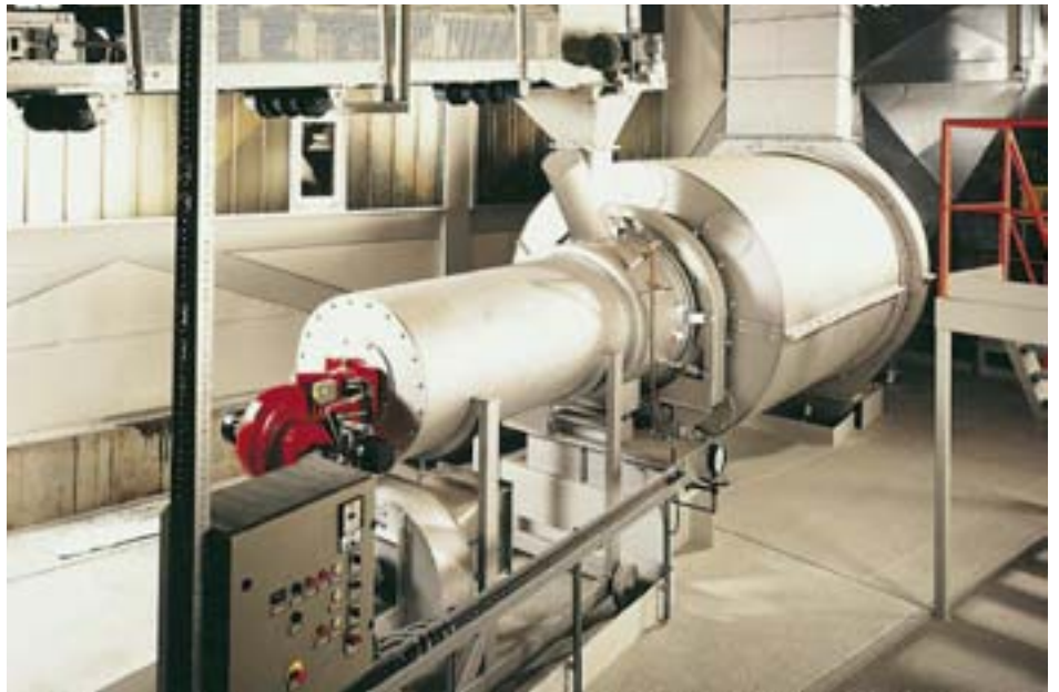
Secador Triplex con generador de gas caliente
