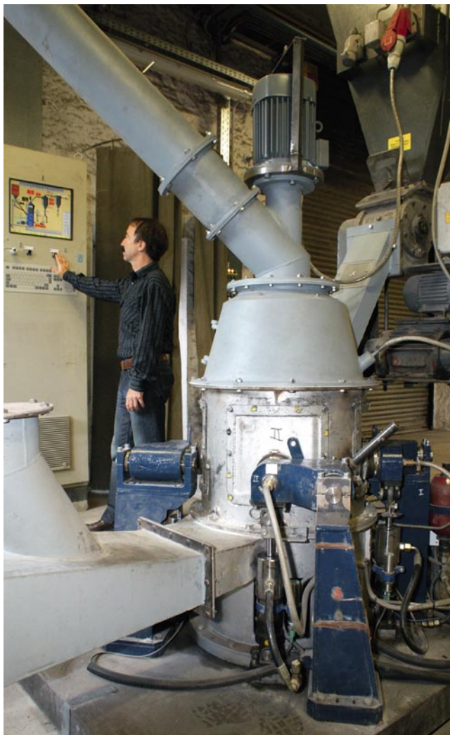
Figure 3: Pfeiffer MVR 400 test mill in Gebr. Pfeiffer AG's test centre Bild 3: Testmühle MVR 400 im Technikum der Gebr. Pfeiffer AG
