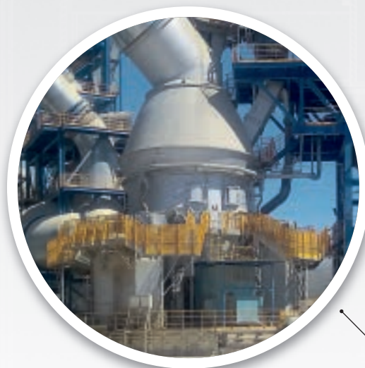
Помол цементного сырья в вертикальных мельницах тип MVR
