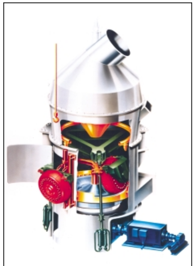
BILD 10: Austausch von Verschleißteilen FIGURE 10: Replacement of wear parts
