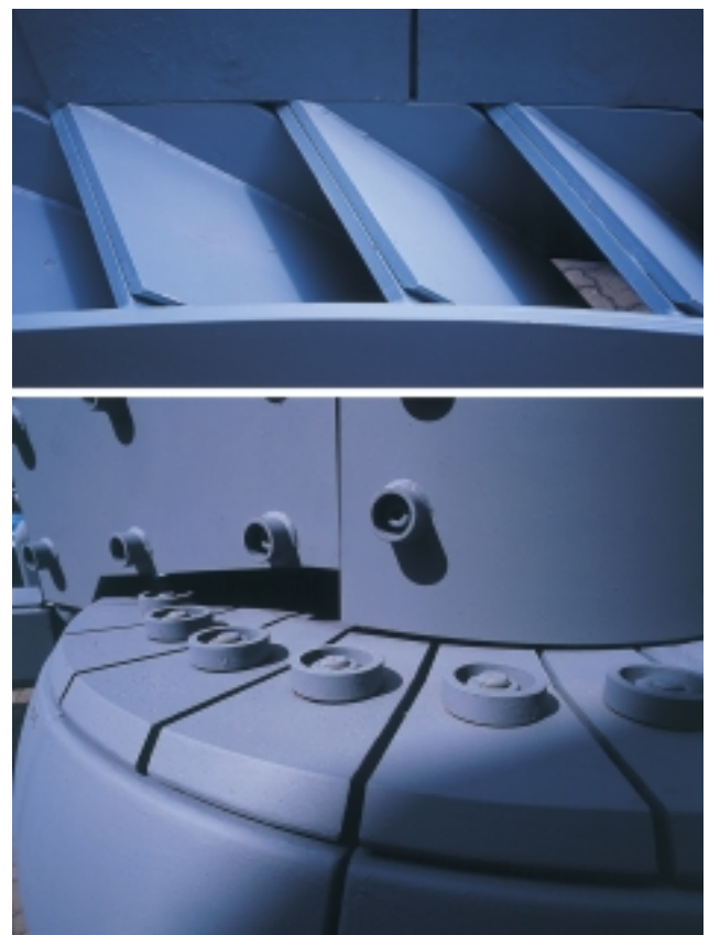
BILD 9: Panzerung von MPS-Bauteilen FIGURE 9: Wear protection measures
