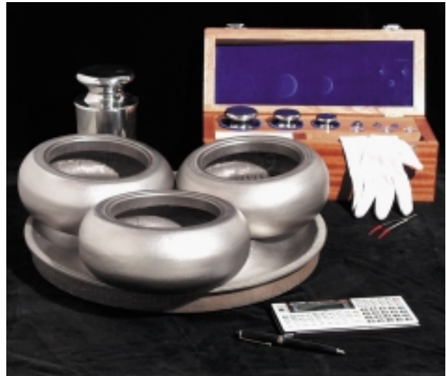
BILD 4: Verschleißteile aus Ni Hard IV für die MPS-Technikumsmühle FIGURE 4: Ni-hard IV wear parts of test mill
