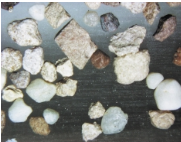
BILD 5: Freier Quarz im Zementrohmaterial FIGURE 5: Free quartz in cement raw material
