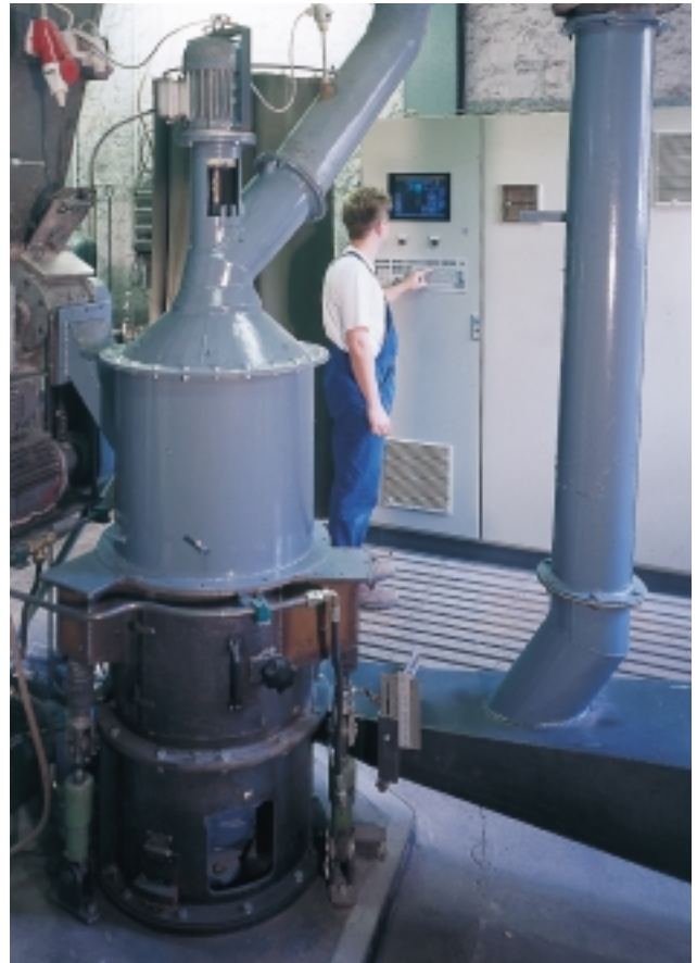
BILD 1: Halbtechnische Pilotanlage MPS 40 B/C mit einem Durchsatz von bis zu 1,5 t/h
