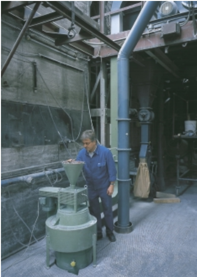
BILD 4: Hochleistungssichter SLV 320 mit einem Aufgabedurchsatz von bis zu 10 t/h
