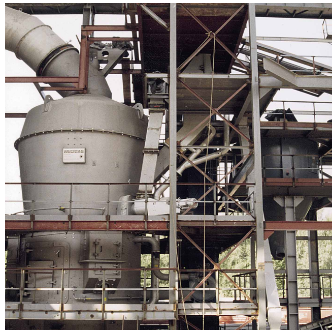
3 MPS 2800 B mit SLS 2450 und Grießeaustrag bei KWC/Polen 3 MPS 2800 B with SLS 2450 and grit discharge at KWC/Poland
