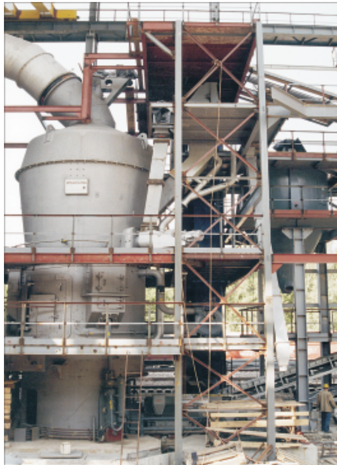
Rys. 4. Młyn misowo-rolkowy 2800 BC Pfeiffera w zakładzie Czatkowice w Polsce.
