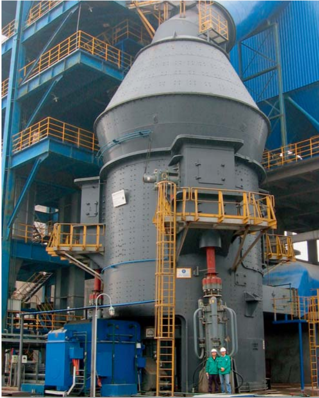
Figure 3: View of the MPS 5600 BC vertical roller mill at Shui On Cement Bild 3: Blick auf die Walzenschüsselmühle MPS 5600 BC bei Shui On Cement
