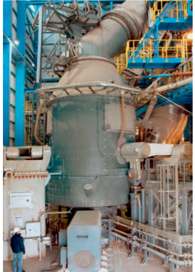
5 MVR-R 3750 para crudo del cemento, 1600 kW, Bosnia Herzegovina MVR-R 3750 para cemento cru, 1600 kW, Bósnia Herzegovina
