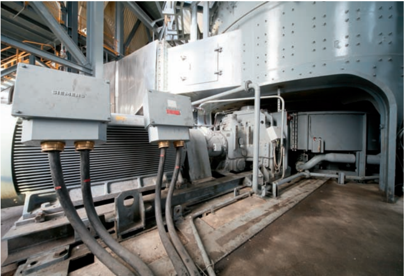
6 MultiDrive® con módulos de 1450 kW, Francia • MultiDrive® con módulos de 1450 kW para Holcim, França
