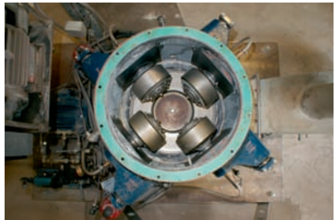
3 Molino de ensayo MVR 400 Gebr. Pfeiffer Moinho de testes MVR 400 Gebr. Pfeiffer
