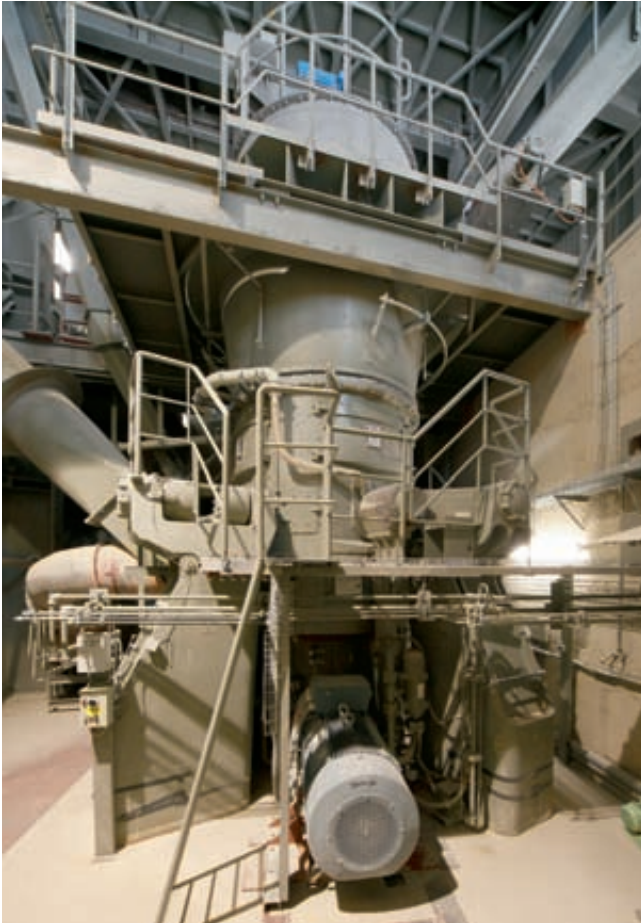
4 MVR 1800, 15 t/h ligante 6000 cm 2 /g, Alemania MVR 1800, 15 t/h ligante 6000 cm 2 /g, Alemanha
